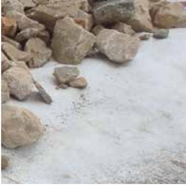
**Séparation des matériaux** (certifié CE par TUV) : Le feutre géotextile permet de séparer efficacement des matériaux de granulométries différentes comme le sable, les pierres, le gravier, la terre végétale. Il évite le mélange des matériaux et conserve l'intégrité de l'aménagement de façon durable. Il évite par exemple que la couche supérieure sable ou gravier, ne soit mélangée aux couches plus profondes notamment dans les allées ou les aires de jeux.
